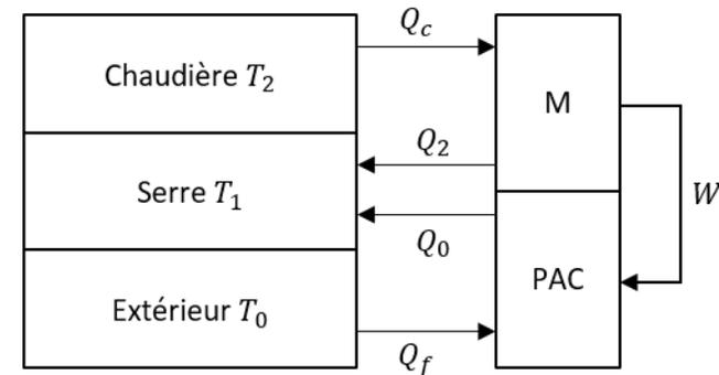
Remarque : les flèches indiquent le sens réel des transferts d'énergie. Toutes les grandeurs  $Q_f$ ,  $Q_0$ ,  $Q_2$ ,  $Q_c$  et  $W$  sont positives.
